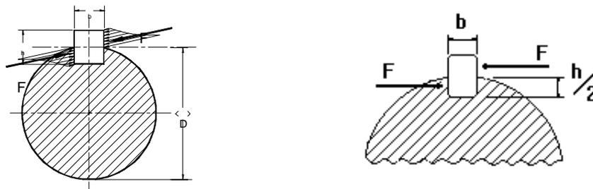
Figura 2 – Conjugado atuante sobre uma chaveta em funcionamento.
